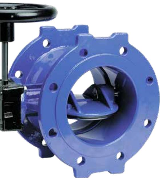
Nous proposons des vannes à papillon double excentrique du DN 150 au DN 2800 conçues pour durer. Le disque incliné et fixe, la conception du joint optimisée et les extrémités de l'axe protégées contre la corrosion sont des caractéristiques qui dépassent les standards du marché.
