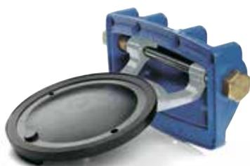
AVK propose une large gamme de clapets à battant à passage intégral et faibles pertes de charges qui permettent d'optimiser les performances de la pompe. Les clapets peuvent être installés en position horizontale ou verticale et sont conçus pour faciliter la maintenance.
