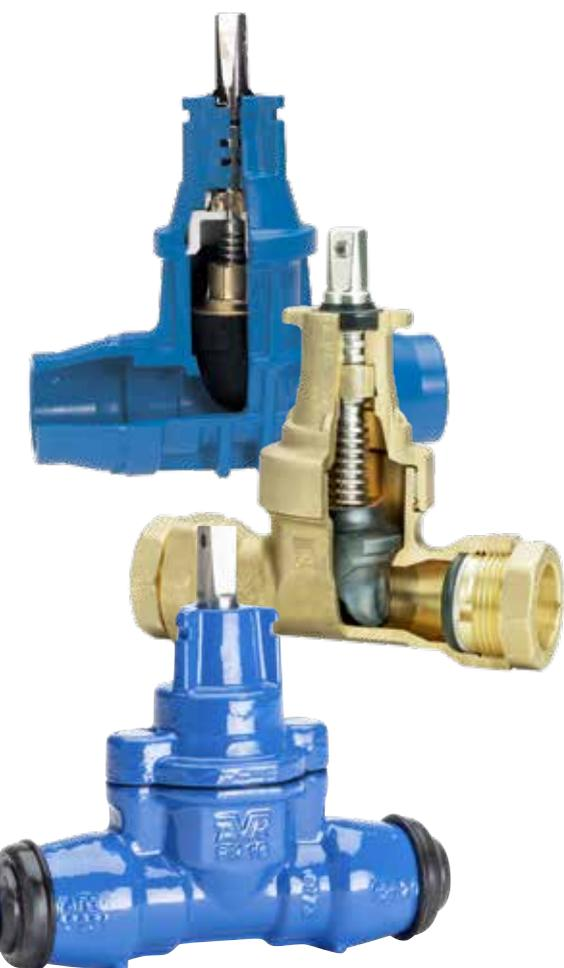
Les vannes AVK sont conçues pour durer et ne nécessitent aucun entretien. Les opercules sont en laiton vulcanisé avec du caoutchouc EPDM approuvé pour l'eau potable, conformément aux réglementations de l'UE.
