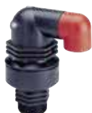
Série 701/40 Ventouse triple fonction DN20, 25 et 50 Filetage BSP 3/4", 1" ou 2" PN 16 Polyamide armé
