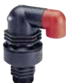
Série 701/40 Ventouse triple fonction DN20, 25 et 50 Filetage BSP ¾", 1" ou 2" PN 16 Polyamide armé
