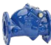
Série 41/61 Clapet à battant Chapeau fermé Siège caoutchouc DN50-300 PN 10/16 Fonte ductile
