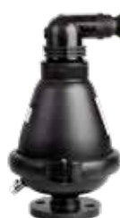
Série 701/75 Ventouse triple fonction Dimensions des orifices : Automatique : 12 mm 2 Cinétique : 804 mm 2 Nylon armé Bride ou filetage BSP 2" ou 3" PN 10 DN50-100
