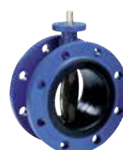
Série 75/20 Vanne papillon concentrique à manchette fixe Double bride à écartement court DN50-2000 Tous types d'actionneurs
