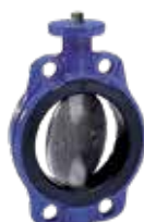
Série 75/31 Vanne papillon concentrique à manchette fixe Demi-oreilles taraudées Fonte ductile DN50-300 Tous types d'actionneurs
