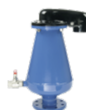
Série 701/78 Ventouse triple fonction Dimensions des orifices : Automatique : 16 mm 2 Cinétique : 5024 mm 2 Acier Bride PN 16 DN80-200
