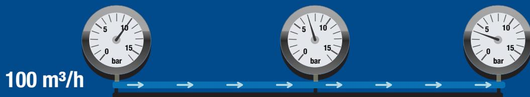
Les pertes de charge dans un réseau dépendent de l'écoulement du fluide
