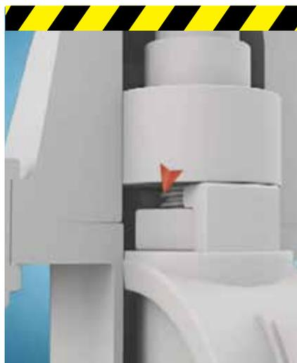
La plupart des vannes sont conçues avec un écrou libre placé dans une baïonnette à l'intérieur de laquelle il est difficile d'obtenir une vulcanisation suffisante. Les écrous libres vibrent selon les variations du flux, menant à l'abrasion de cette fine couche de caoutchouc.
