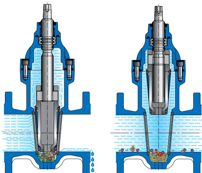
Siège de vanne à opercule métallique concurrente
