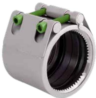
La gamme Repico® en acier inoxydable 316 se compose de manchons type “Grip” (version verrouillée) pour tuyau métallique jusqu’au DN400 et les manchons type “Slip” (version libre) pour tout type de tuyau jusqu’au DN2000. Les manchons Repico® conviennent aux applications eau potable et assainissement.
