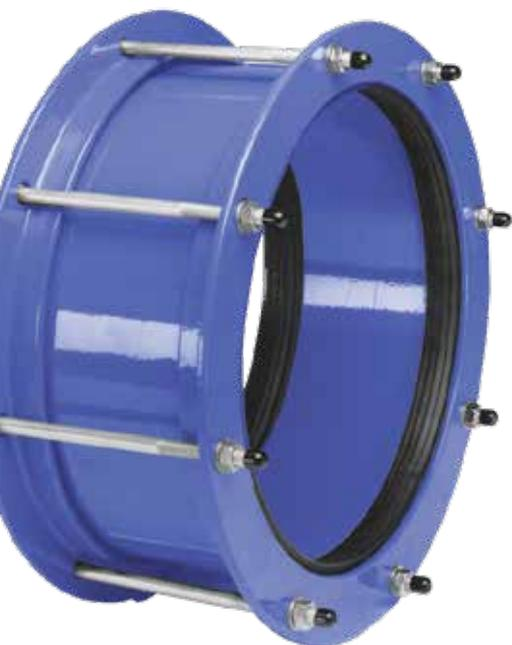
La gamme de raccords AVK comprend des manchons non autobutés symétriques, dissymétriques et adaptateurs à bride mécano soudé du DN350 à 2000. Cette gamme est adaptée aux conduites en fonte ductile, fonte grise, acier, PVC et GRP pour eau potable et eaux usées jusqu'à 25 bar.
