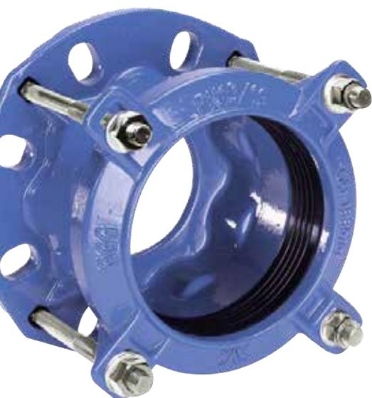
Les manchons universels symétriques, dissymétriques et adaptateurs à bride de la gamme Supa® AVK sont adaptés aux tuyauteries PVC, fonte grise, fonte ductile, acier et fibreciment. La gamme de DN40 à 400 convient aux applications en eau potable et eaux usées.
