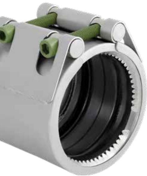
La gamme Repico® en acier inoxydable 316 se compose de manchons type “Grip” (version verrouillée) pour tuyau métallique jusqu’au DN400 et les manchons type “Slip” (version libre) pour tout type de tuyau jusqu’au DN2000. Les manchons Repico® conviennent aux applications eau potable et assainissement.
