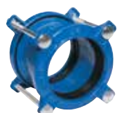
Série 601 Manchon grande tolérance symétrique Supa® pour PVC, fonte grise, fonte ductile, acier et fibre ciment Fonte ductile DN 40-400 PN 16
