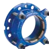
Série 623/10 Adaptateur à bride Supa Plus™ autobuté pour PVC et PEHD Perçage universel Fonte ductile DN 40-300 PN 10/16
