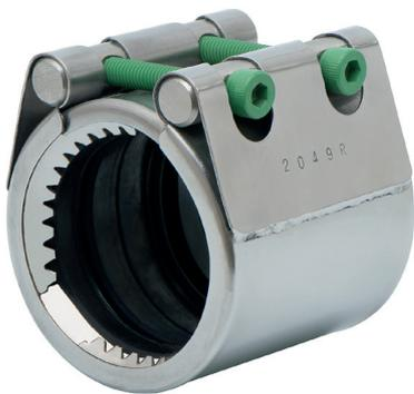
Le manchon Repico® type Grip s'ancre dans le tuyau grâce aux bagues de crampage, limitant ainsi le mouvement du tuyau. La pression du fluide vient augmenter l'étanchéité en comprimant le caoutchouc contre le tuyau et en ancrant d'autant plus les bagues de crampage.
