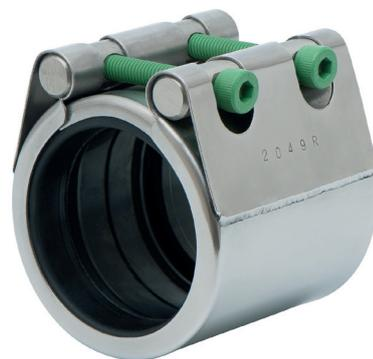
Le manchon Repico® type Slip effectue l'étanchéité grâce au joint en caoutchouc. Le buttage de la conduite est nécessaire car le manchon n'a pas de bague de crampage. Selon le diamètre et l'application, les manchons sont également disponibles en versions à 2, 3 ou 4 blocages.
