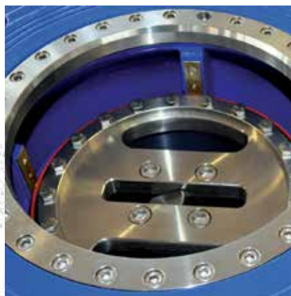
Joint de haute qualité, situé dans une zone hors du fluide, facilement remplaçable sans démonter la vanne de la canalisation.
