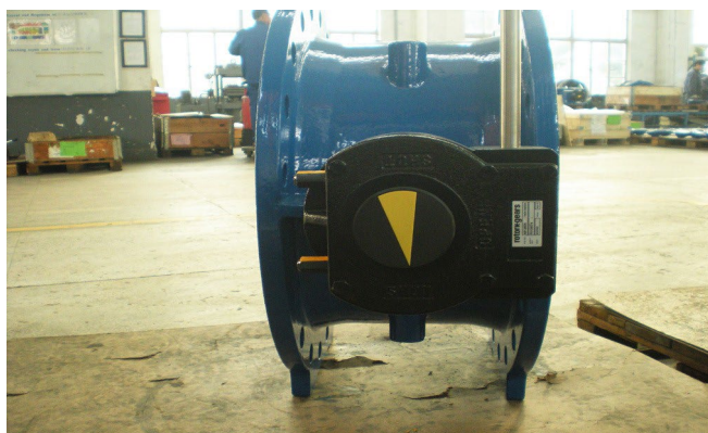
Contrôle de l'indicateur de position – étape 4
