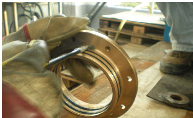
Montage et graissage des joints toriques – étape 3
